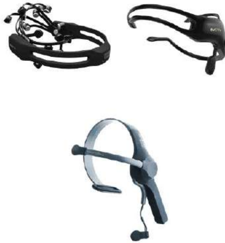
Şekil 1. Giyilebilen ve taşınabilen EEG cihazları (URL-1, 2018; URL-2, 2015).
