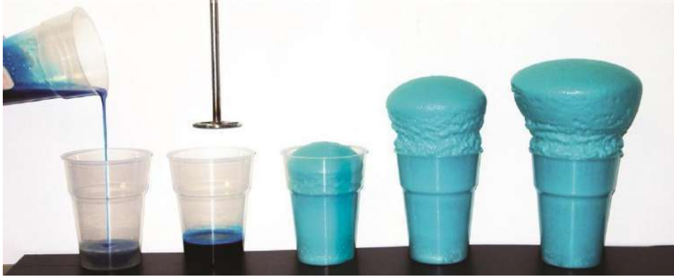
Şekil 1. Standart laboratuvar kabında poliüretan köpük üretim aşamaları ( http://www.erapol.com.au/technical/foam/properties/ )
