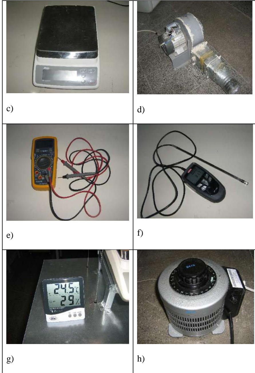
Şekil 2. Deney düzeneğini oluşturan ana elemanlar; a) Kurutma kabini ve hava akış kanalı, b) Isıtma sistemi, c) Dijital terazi, d) Fan, e) Voltmetre, f) Anemometre, g) Nemölçer, h) Varyak
