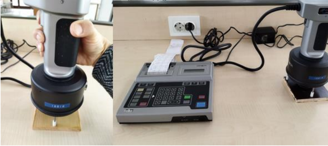
Resim 3.1. Renk ölçüm cihazı (Minolta CR-231, 1990)
