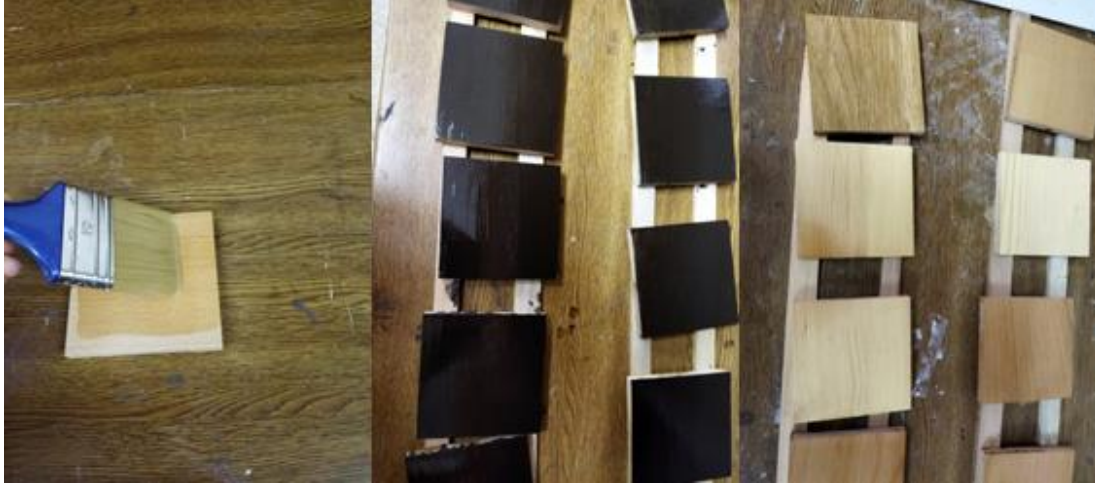
Resim 2.3. Deney örneklerinin verniklenmesi
